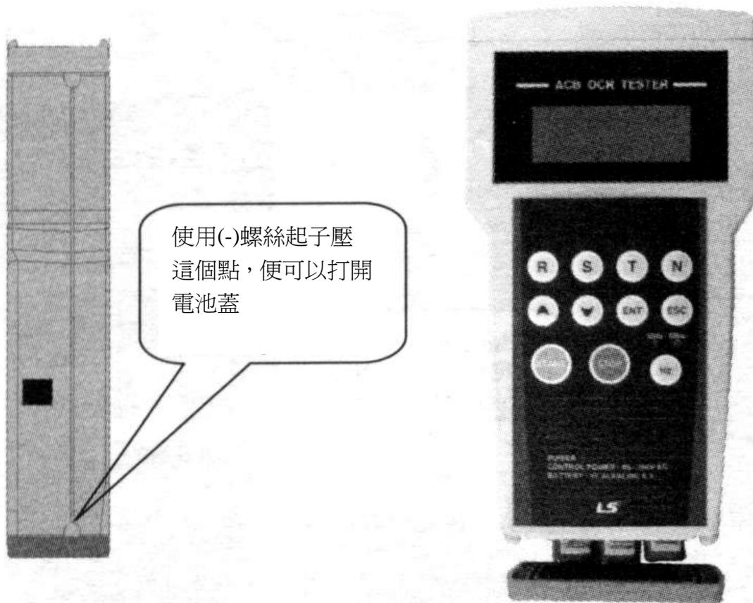
測試器的電池蓋分離圖示
